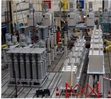
Den 160 kV mekaniska DCCB-prototyp som användes i testerna
