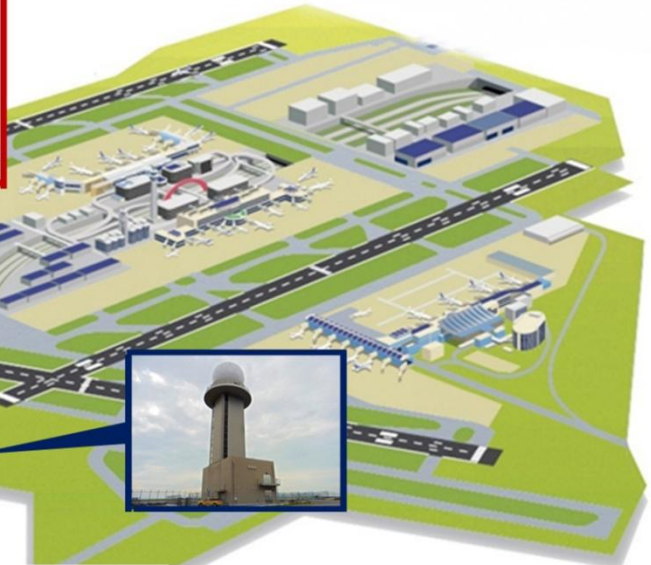
Terminaldoppler för väderradar För att känna av vindskjuvning vid väderförhållanden med nederbörd
