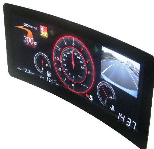
Böjd färg-TFT-LCD-modul med nyutvecklad teknik (800 mm krökningsradie)
