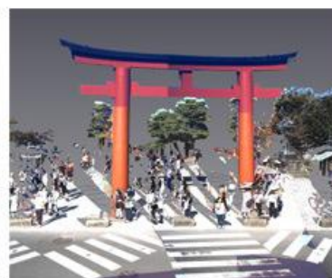
3D-punktmoln skapat från data erhållna via MMS
