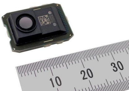
MelDIR-IR-värmediodsensor på 80 x 60 pixlar (MIR8060C1) med 100 x 73 graders synfält
