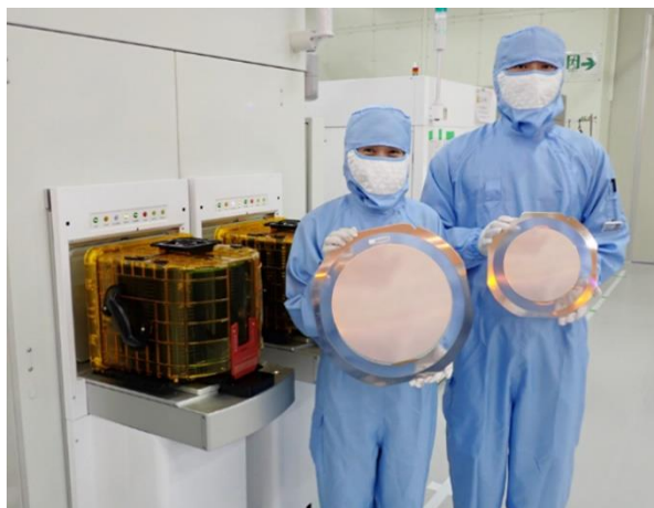
12-tums kiselwafer och mätutrustning för motstånd, visas som referens vid sidan av en 8-tums wafer (höger)
