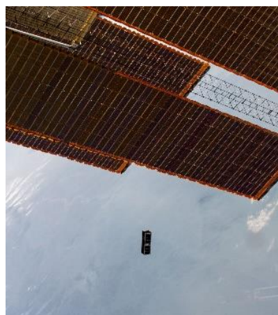
Nanosatelliten sköts upp från ISS (med tillstånd av JAXA/NASA)
